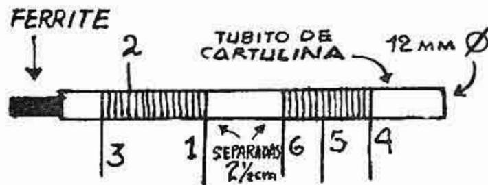
BOBINA DE ALAMBRE DE COBRE ESMALTADO DE 0,5 MM. Ø
