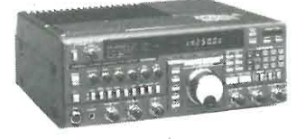
YAESU FT767 Nuovissima linea gestita da \mu P. Ricetrasmittitore HF - Copertura continua 100 kHz-29.999 MHz con accordatore automatico. Alim. 220V entrocontenuta.
